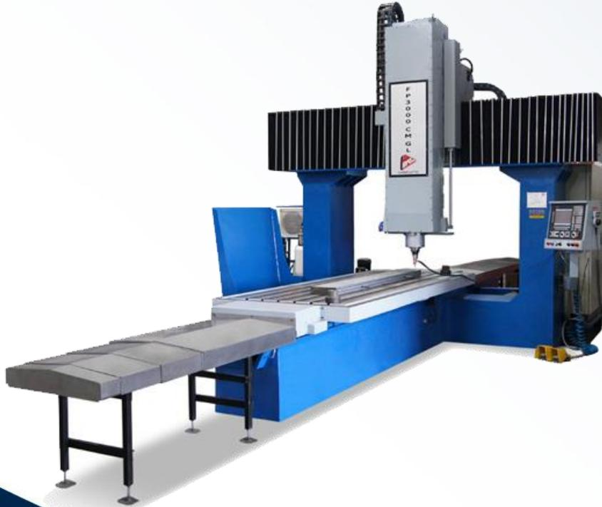
**Máquina – Fresadora Portal CNC CHINELATTO
